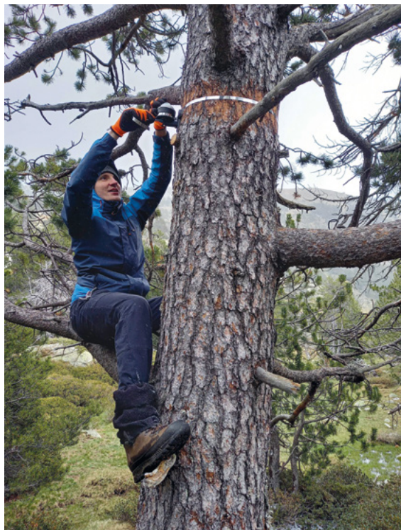
▲ Jan Tumajer při terénním výzkumu. Snímek zachycuje instalaci dendrometru pro záznam změny velikosti kmene borovice v hodinovém časovém rozlišení. Foto dr. Jelena Lange
